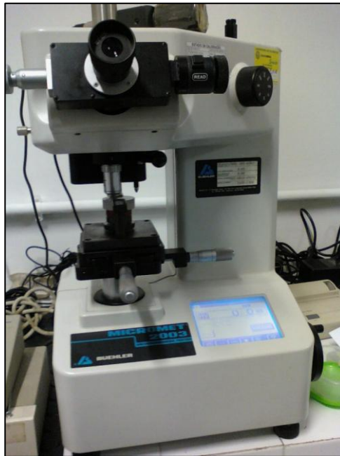
Fig. 5 Microdurômetro utilizado no ensaio para obtenção da microdureza Vickers.
