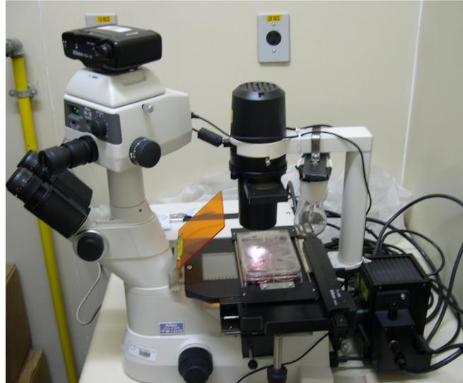
Figura 3. Microscópio invertido Nikon Eclipse TS 100, com máquina Nikon FDX 35 acoplada.
