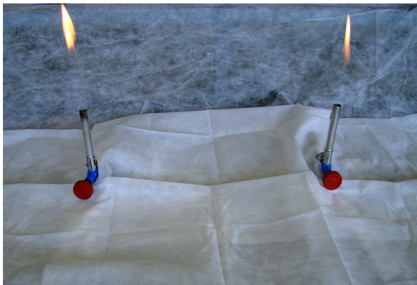
Figura 1. Área de segurança entre a chama de dois bicos de bunsen, e sobre campo estéril
