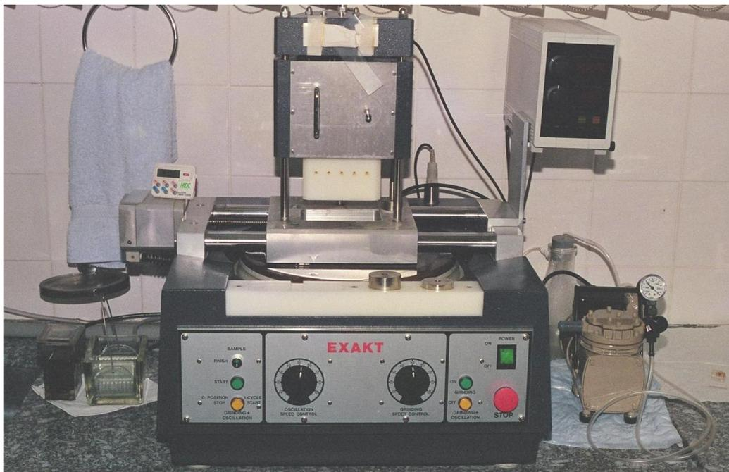
*Figura 8 – Sistema de desgaste EXAKT. Desgasta os espécimes cortados com 100  $\mu\text{m}$  de espessura para 10  $\mu\text{m}$ .*
