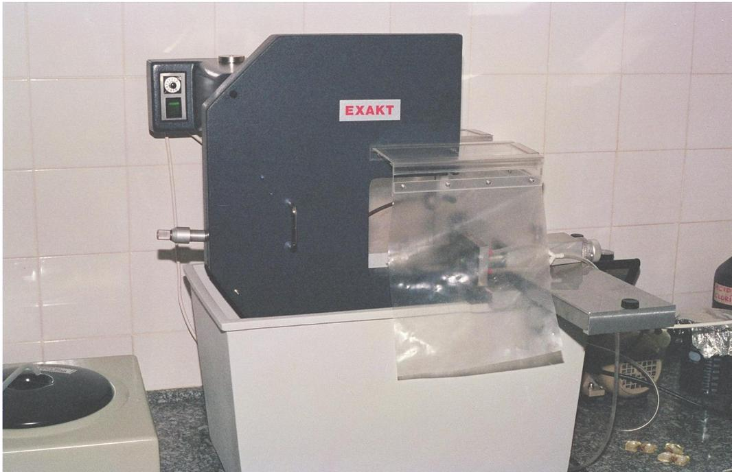
*Figura 7 – Sistema de corte EXAKT. Realiza cortes de 100  $\mu\text{m}$ .*
