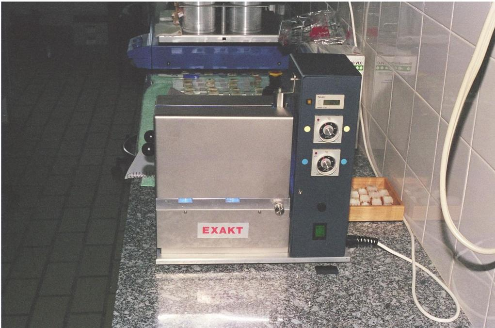
*Figura 6 – Sistema de polimerização da resina de embutimento*
