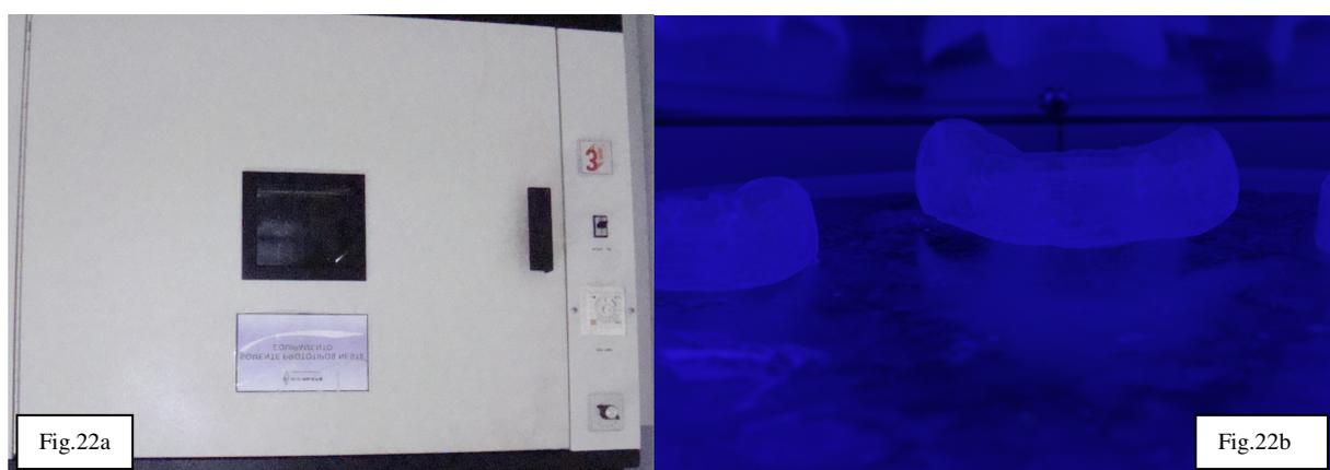
Figuras 22a e 22b- Fotopolimerizadora para cura da resina do guia sialitográfico. Fonte: Dados da pesquisa.
